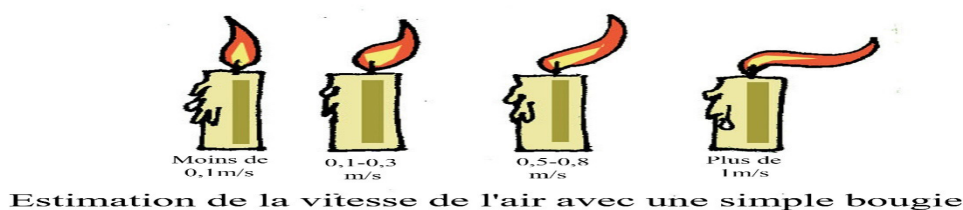
Figure 28. Estimation de la vitesse de l'air avec une simple bougie
